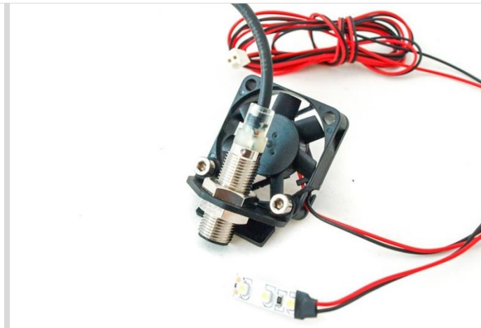
105 Place fan as shown in the image. NOTE the orientation of the fan and als the position of the cable
